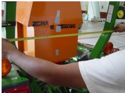
*Figura 51 Medición del ancho de la estructura de protección*
