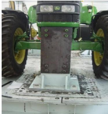
*Figura 64 del tractor a la plataforma del banco de pruebas de la parte delantera*
