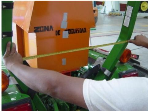
*Figura 50 Medición del ancho interior de la estructura a nivel del volante*
