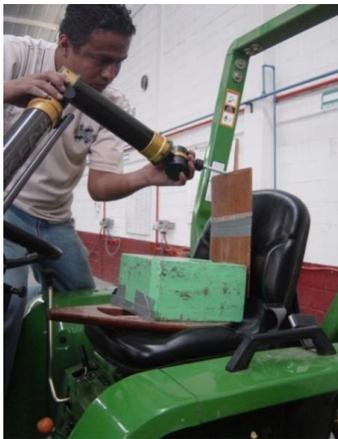
*Figura 35 Medición de las coordenadas X, Y y Z del punto D con el SPMC*
