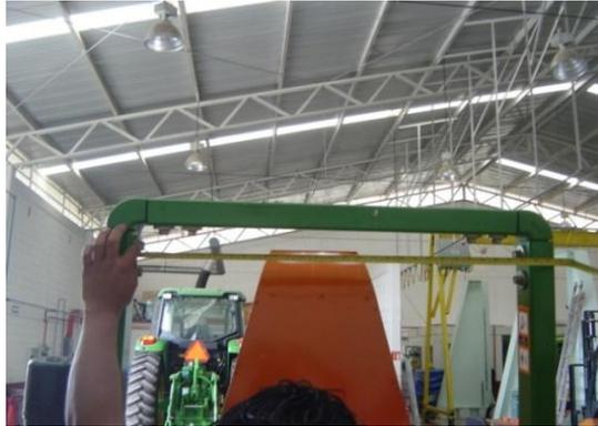
*Figura 48 Ancho interior de la estructura de protección a 900 sobre el PRA*
