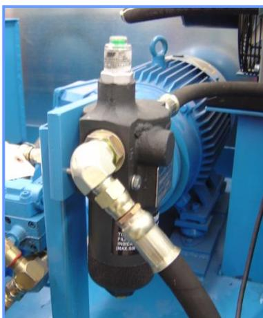
La función primaria del filtro W440 es reducir o eliminar contaminaciones indeseables de los líquidos antes de que atraviesen los componentes sensibles del sistema. Estos contaminantes, cuando fluyen en el sistema libremente puede causar desgaste, mal funcionamiento, y la falla de muchos componentes. Sin importar condiciones, la contaminación es inherente en cada líquido del sistema. Es influenciado por muchos factores, generados por componentes mecánicos, y recogido por el líquido que circula.
