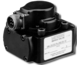
El SM4 servovalvula, cuando es usada con un cilindro hidráulico, transductor de posición, y eléctricos apropiados, puede proporcionar el mando de posición de cilindro infinito dentro de 0,025 mm (0.001 pulgadas) o bien, dependiendo de los componentes seleccionados, longitud de movimiento y características de la carga.
