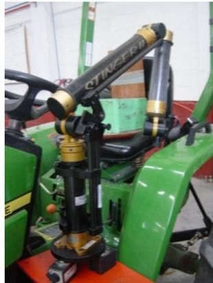
*Figura28 Montaje de SPMC al tractor*
