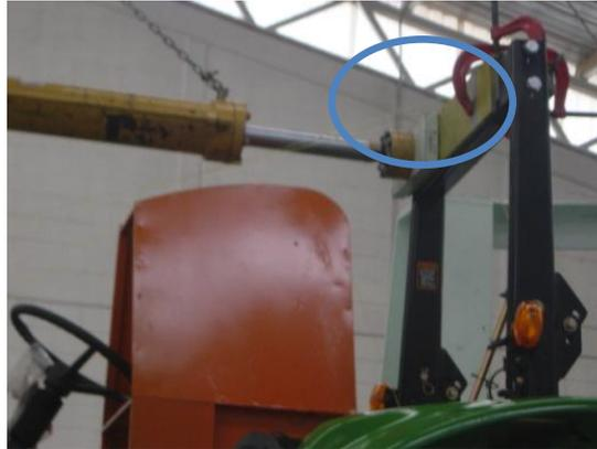
*Figura 102 Dispositivo para aplicación de carga frontal*
