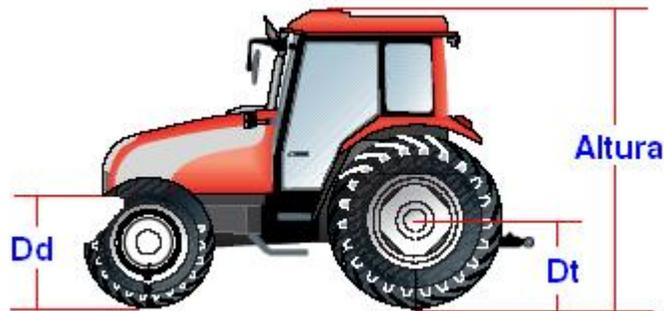
**Figura 2. Dimensiones para determinar el alto de las masas de fijación delanteras y traseras.**
