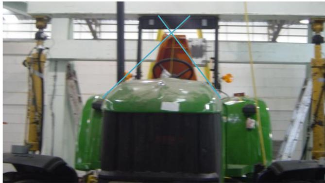
*Figura 83 Proyección de líneas en volcadura hacia delante*
