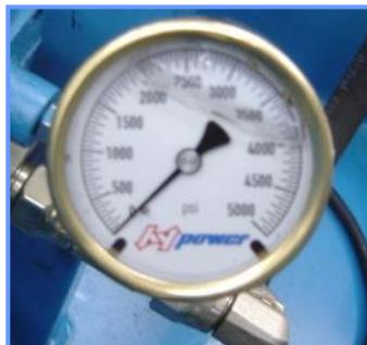
Medidor de presión marca HYPOWER, diseñado para larga vida en condiciones severas de operación, el baño de glicerina humedece el movimiento del indicador, tubos de
