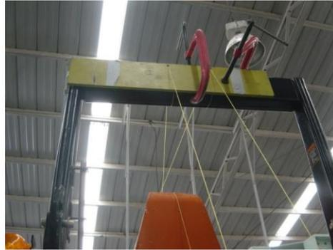
*Figura 89 Punto de aplicación de carga trasera*
