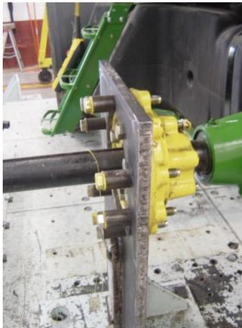
*Figura 61 Fijación del tractor a la plataforma del banco de pruebas de un eje trasero*
