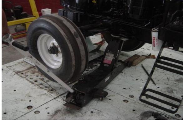
*Figura 62 Colocación de gato hidráulico en eje delantero*
