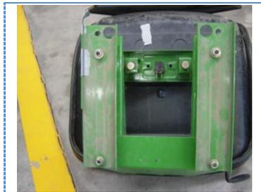
*Figura 107 Montaje del asiento al tractor*
