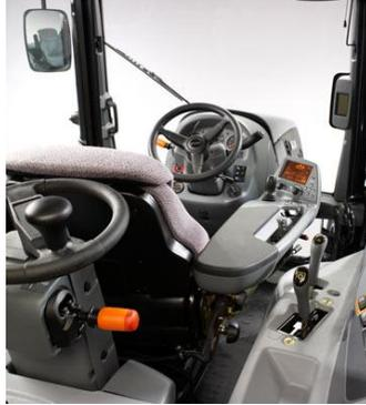
Figura 6 Asiento con posición de operador reversible
