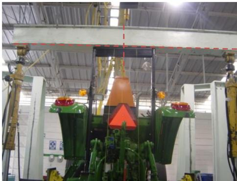
*Figura 95 Colocación de viga de compresión*
