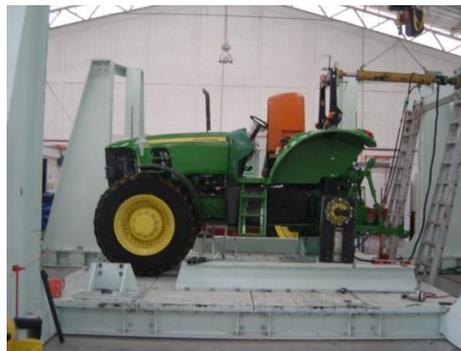
*Figura 57 Extracción de la llanta trasera del tractor*
