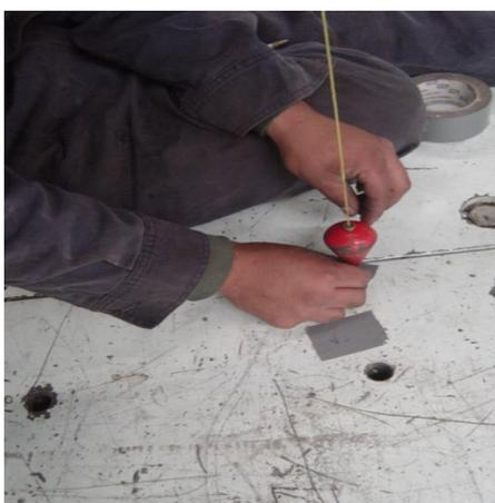
*Figura 74 Proyección de puntos con la estructura de protección deformada después de prueba de resistencia*
