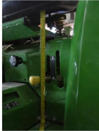
*Figura 19 Distancia de un punto del asiento respecto de un punto de referencia del tractor
