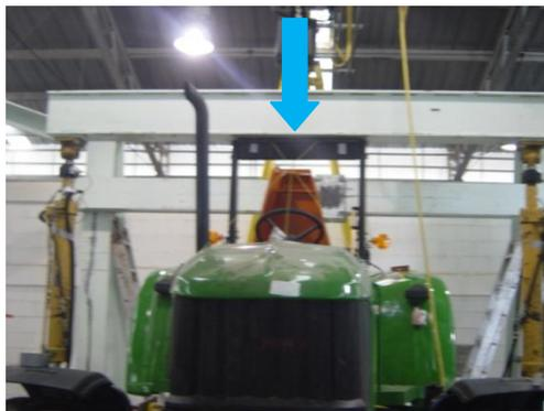
*Figura 97 Aplicación de fuerza vertical de compresión*
