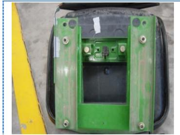
El asiento se fija a la base por medio de dos placas fijadas con cuatro tornillos, adelante tiene un mecanismo que deja girar al asiento hacia adelante. La suspensión es de resorte, no tiene perilla de regulación para la suspensión.
