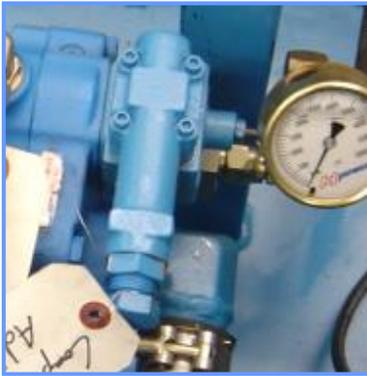
El controlador compensador de presión ajusta automáticamente la entrega de la bomba para mantener el volumen requerido de operación del sistema a la preseleccionada presión. La entrega máxima de la bomba es mantenida a aproximadamente 75 PSI debajo del ajuste de presión antes de ser reducida. El controlador compensador opera en un lado del centro y tiene un rango de ajuste según lo señalado en la enumeración modelo
