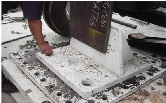
*Figura 59 Colocación de base de fijación delantera*
