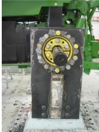
*Figura 60 Colocación de la masa trasera a eje*
