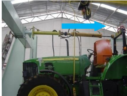
*Figura 99 Punto de aplicación de carga frontal*
