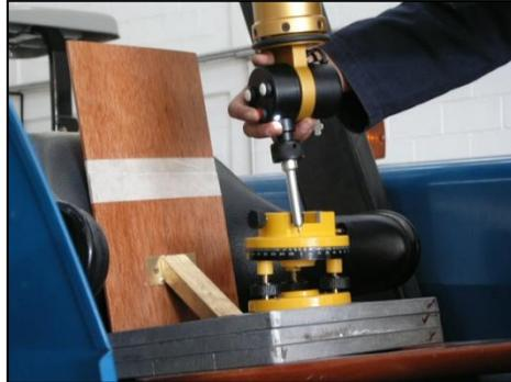
**Figura 2. Palpación del plano eje Z.**
