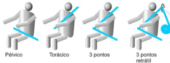
Figura 11 Tipos de anclaje
