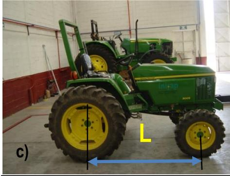
Figura 16 Determinación de puntos extremos delanteros, b) Determinación de puntos extremos traseros y c) Determinación de distancia entre ejes
