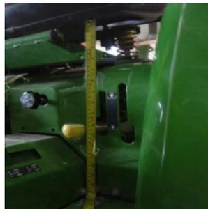
Figura 24 Distancia de un punto del asiento respecto de un punto de referencia del tractor
