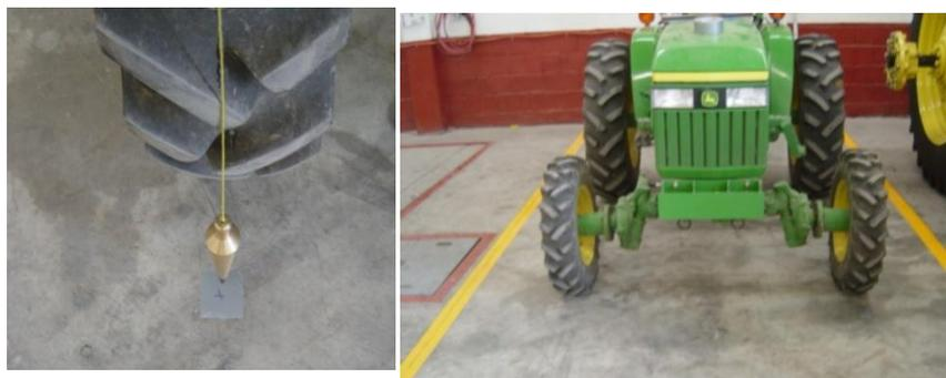
Figura 17 Proyección de los puntos con la plomada de las llantas delanteras y traseras
