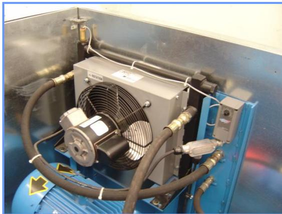
Enfriador de aceite con retiro de calor por arriba de los 80 hp, fluido de aceite a 150 GPM, Incluye soportes para montarlo, conexiones según SAE con motor monofásico y variador de temperatura de enfriamiento.
