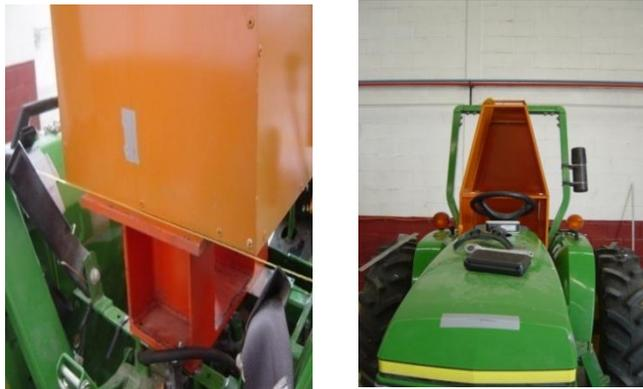
*Figura 42 a) Alineación de zona de seguridad con centro de volante y b) a la altura del lazo*
