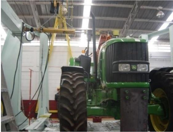
*Figura 104 Punto de aplicación de carga lateral*
