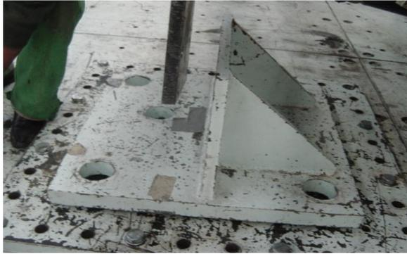
*Figura 58 Colocación de base de fijación trasera*
