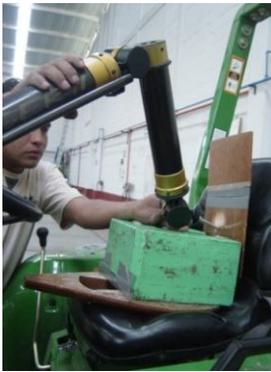
*Figura 34 Medición de las coordenadas X, Y y Z del punto C con el SPMC*
