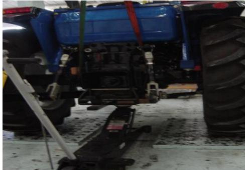
*Figura 56 Colocación de gato hidráulico en medio de los dos ejes traseros*
