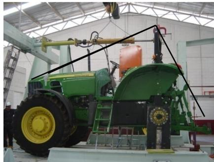
*Figura 103 Aplicación de carga frontal*
