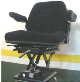
Figura 9 Asiento con suspensión mecánica
