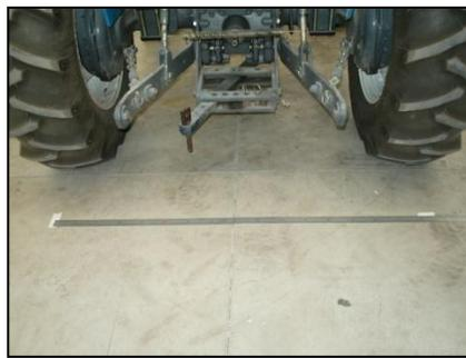
**Figura 4. Medición del ancho de trocha trasera (separación A).**
