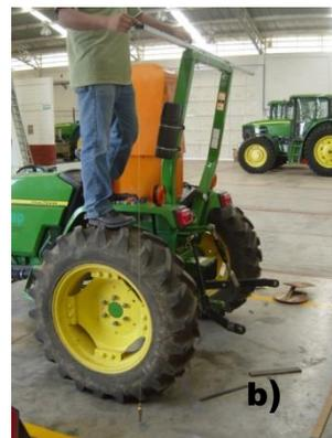
*Figura 73 a) Nivelación y b) proyección de punto izquierdo del tractor*
