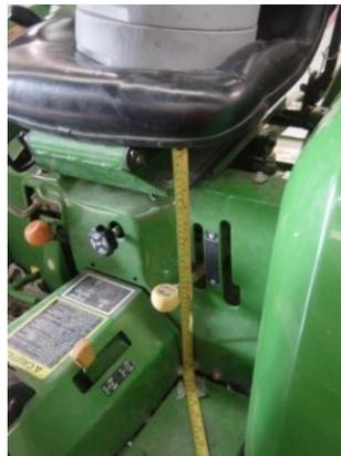
*Figura 20 Distancia de un punto del asiento respecto de un punto de referencia del tractor
