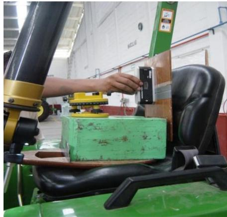
*Figura 30 Nivelación de respaldo con nivel digital*
