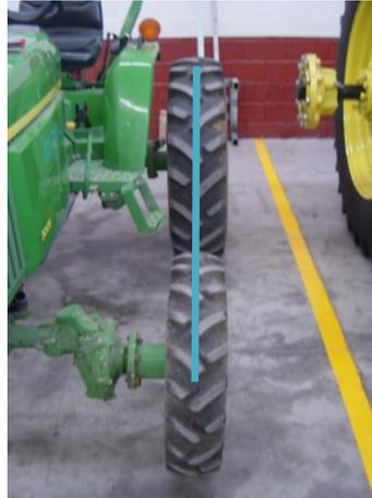
*Figura 21 Alineación del tractor*
