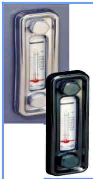
Indicador de nivel y temperatura del aceite en el depósito, puede ser montado en el exterior o interior del depósito. Requiere solamente dos agujeros de montaje todas sus piezas externas son de acero inoxidable, tiene una lupa No-frágil 2X, su marcador de termómetro es estándar con grados centígrados y Fahrenheit, soporta temperatura de hasta 225 °F (107°C).
