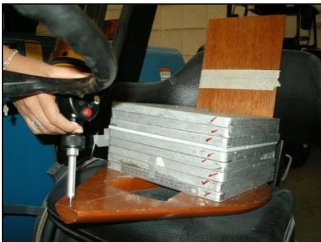
*Figura 32 Medición de las coordenadas X, Y y Z del punto A con el SPMC*
