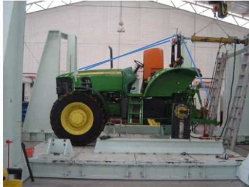
*Figura 94 Verificación de zona de seguridad*
