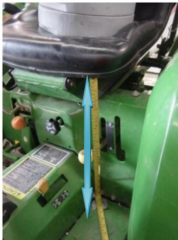
*Figura 26 Distancia de un punto del asiento a un punto de referencia del tractor*
