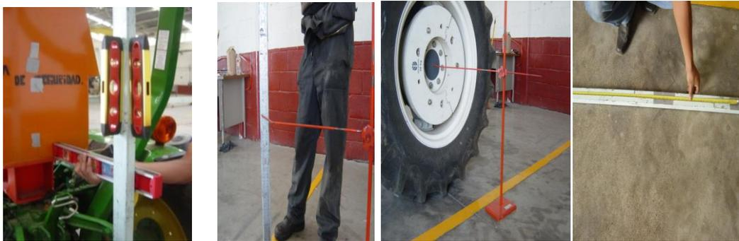
*Figura 39 Proyección del PRA al suelo, proyección de eje trasero en trusquin, proyección de trusquin en perfil, y medición de distancia entre eje y PRA (punto 6)*
