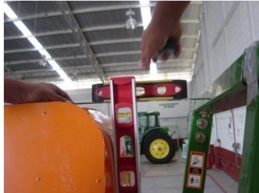
*Figura 52 Distancia horizontal del PRA a la parte trasera de la estructura a 900 mm sobre el PRA*
