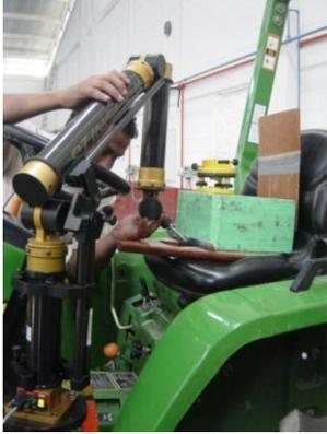
*Figura 33 Medición de las coordenadas X, Y y Z del punto B con el SPMC.*
