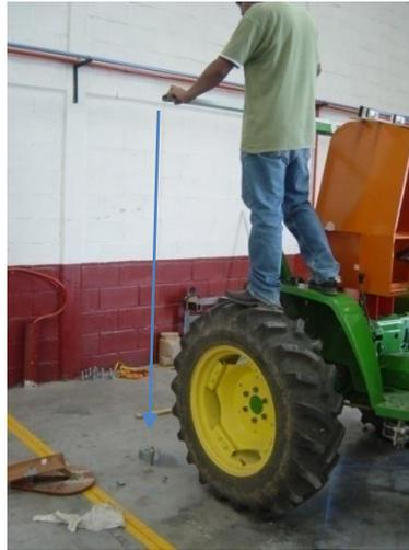
*Figura 71 Nivelación del punto derecho lateral*
