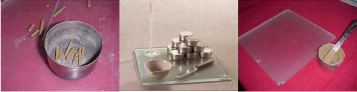
Figura 29. Procedimiento para determinar el límite plástico.
