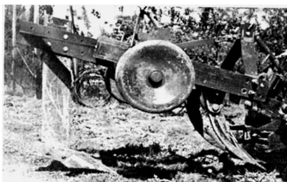
Figura (2.3) Subsolador combinado con rejas aladas en la parte inferior del subsolador.
