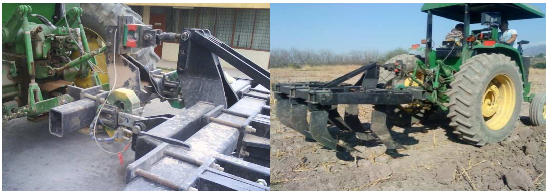
Figura (3.16). Transductores Octagonales montados en un bastidor acoplado al tractor.
