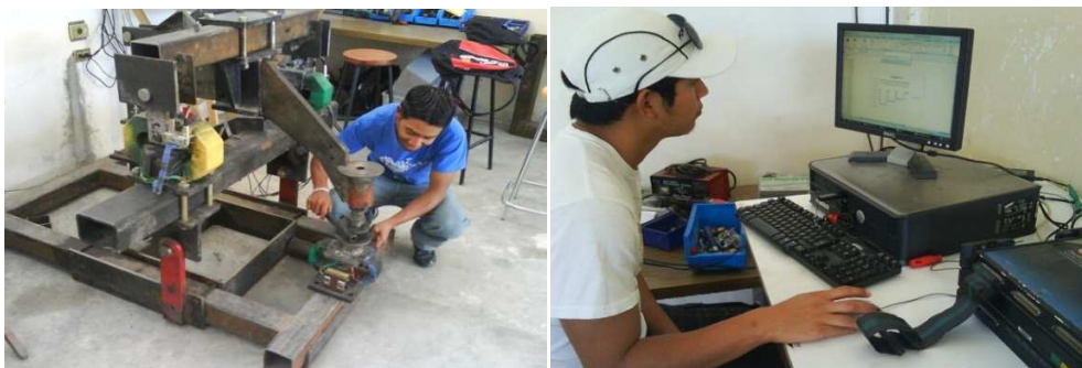
Figura (3.14) Calibración de los sensores a través de un gato hidráulico.
