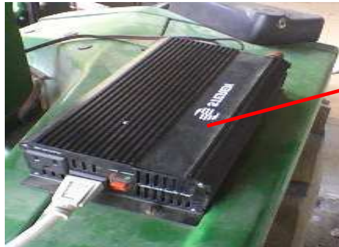
Figura (3.11) CONVERTIDOR DE CORRIENTE
