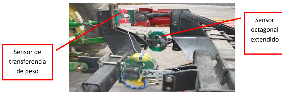
Figura (4.2). Sensor integral de 80 kN empleado en la determinación de la fuerza de tiro. Integrado por, (a) sensor de transferencia de 40 kN. (b) sensor octagonal de 40 kN.
