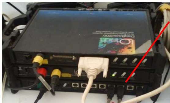
Figura (3.9). AMPLIFICADOR Y ACONDICIONADOR DE SENAL DBK43A
