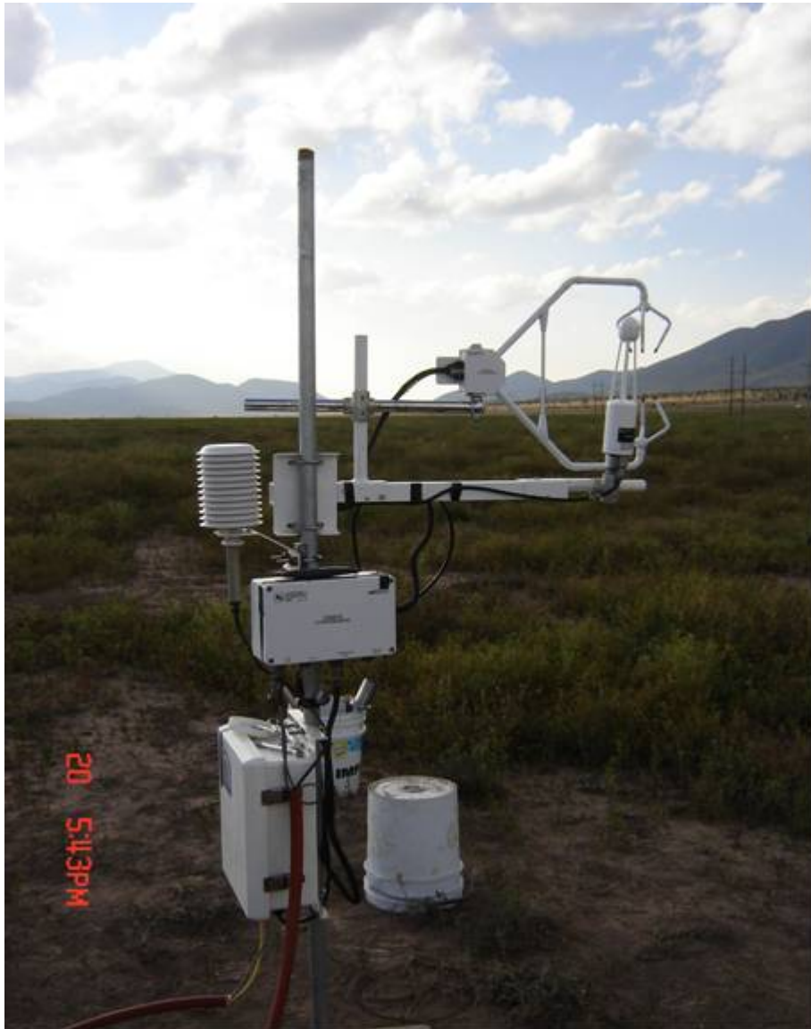
Figura 3.3 Sistema eddy en la parcela testigo (sin movimiento de suelo) para medir los flujos de calor latente ( \lambda E ) y flujo de CO_2 entre la superficie y la atmósfera circundante.
