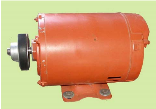
Figura 3.3. Motor eléctrico 745.7 W (1 hp), marca siemens.
