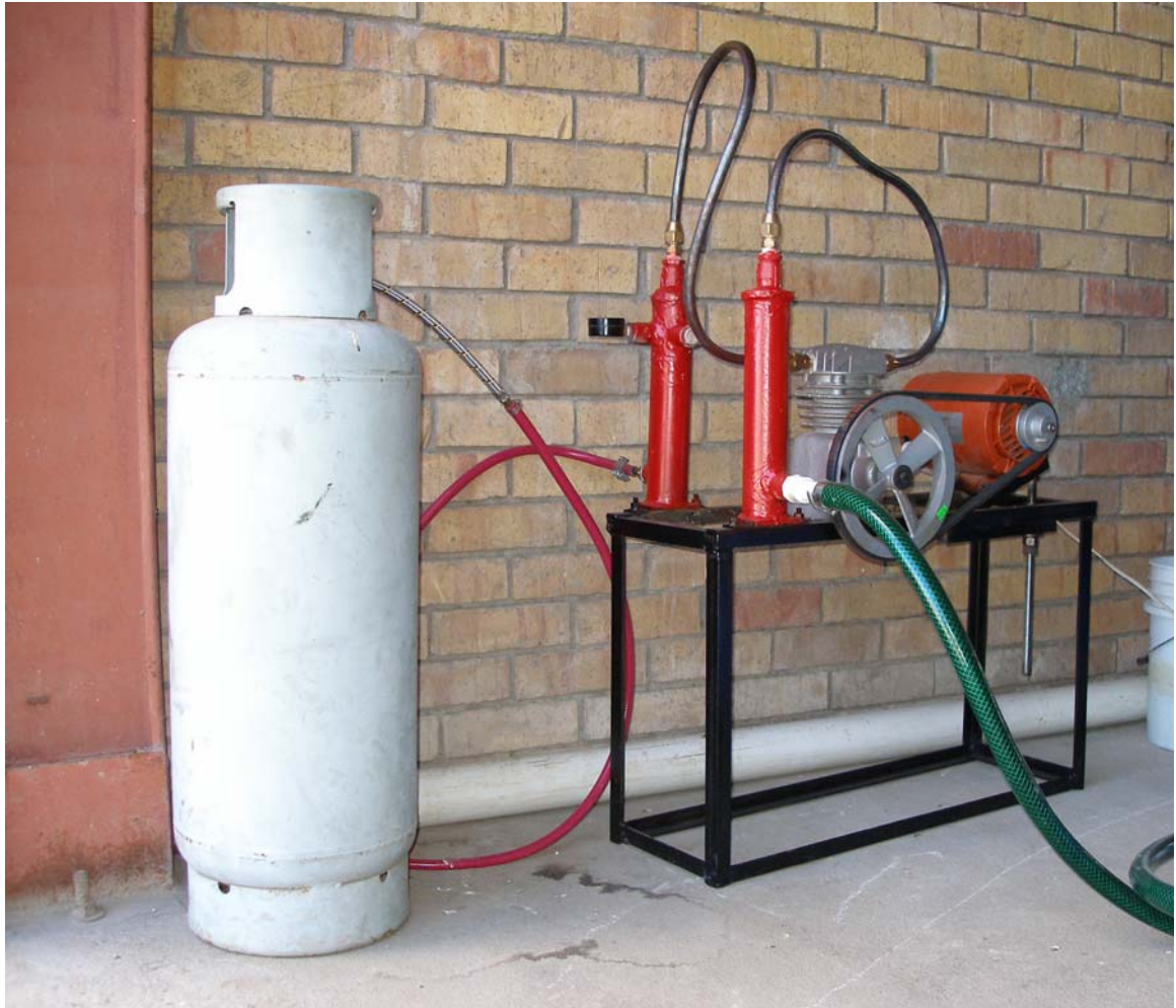
Figura 3.5. Resultado final del ensamble del compresor.
