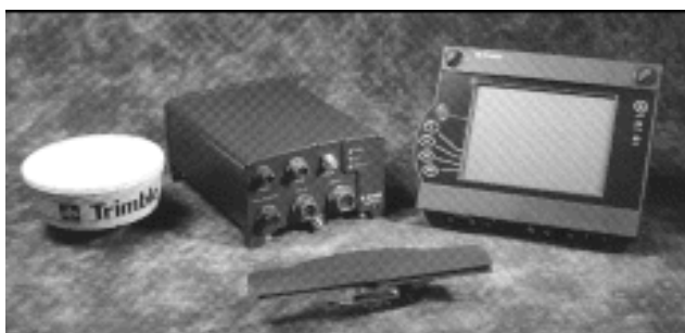
Fig. 17 - Equipo aéreo con pantalla digital y barra de luces
