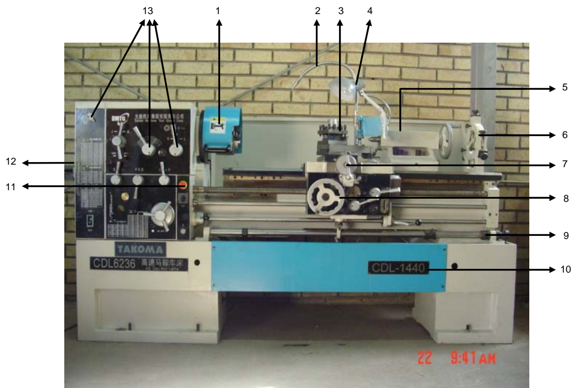
Fig. 3.1 Partes del torno.
