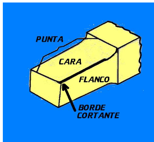
Fig. 2.10 Partes más importantes de una herramienta de corte.
