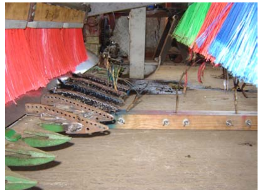
Figura 4.8. Evaluación en laboratorio utilizando cerdas levantadoras
