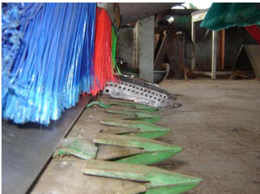
Figura 4.3. Cerdas adheridas sobre las guardas.
