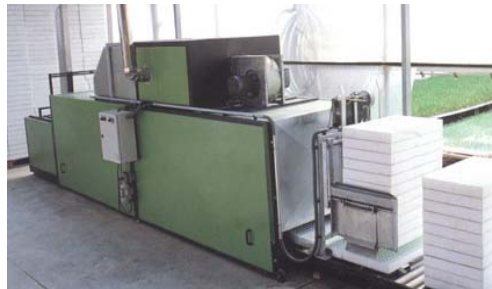
Fig. (3.6.1.3). Equipo para la pasteurización de las bandejas por medio de calor.
