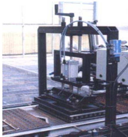
Fig. (3.6.1.9). Sistema de punzonado automático.
