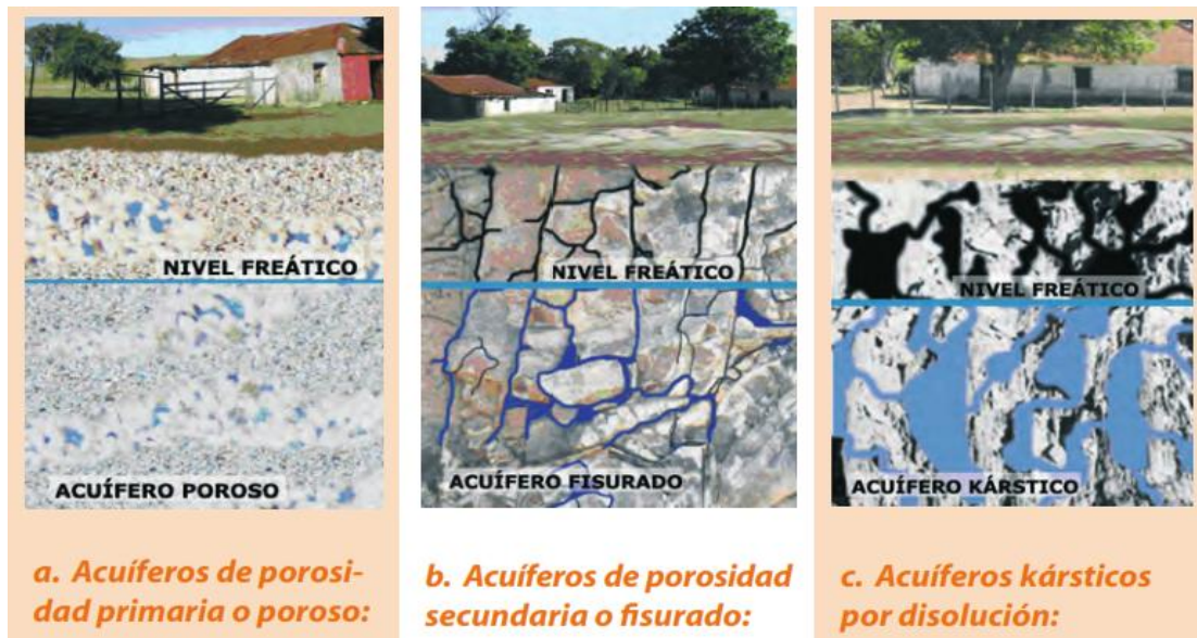
Figura 3. Clasificación de los acuíferos en función del tipo de porosidad.
