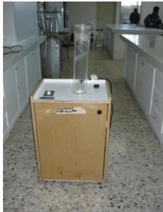
Figura 3.1 Soplador “South Dakota” marca Seedburo del Laboratorio de Producción de Semillas del CCDTS.
