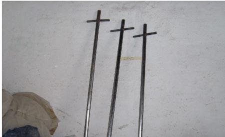
Figura 5.2 Inyectores para la aplicación de fumigante en pastillas o comprimidos.
