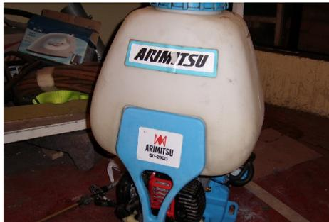
Figura 4.2 Máquina de motor marca arimitsu para la aplicación de insecticida.
