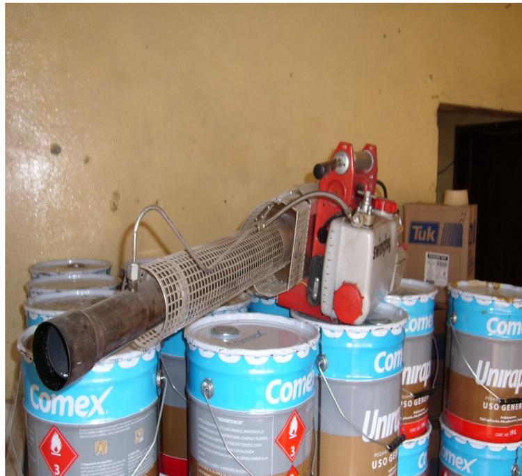
Figura 4.5 Termonebulizador marca swingfog para la aplicación de insecticida en niebla o nebulización.
