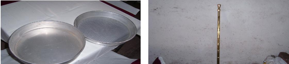
Figura 6.2 Zarandas y calador para el muestreo de grano almacenado.
