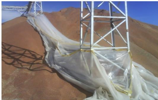
Figura 6.6 Acomodamiento y pegado del plástico o lonas sobre el grano almacenado.
