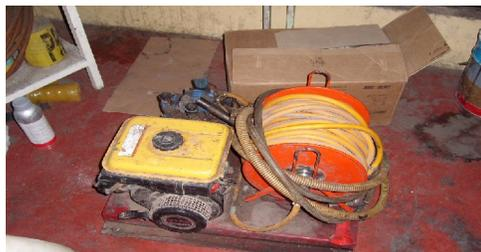
Figura 4.3 Motobomba o parihuela con manguera de 30 m de largo para la aplicación de insecticida.
