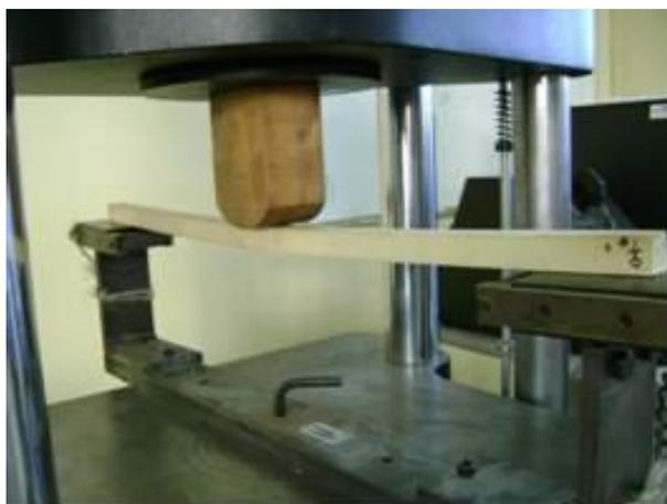
Figura 23. Ensayo de flexión estática en probetas de *Dasyliirion cedrosanum* Trel.
