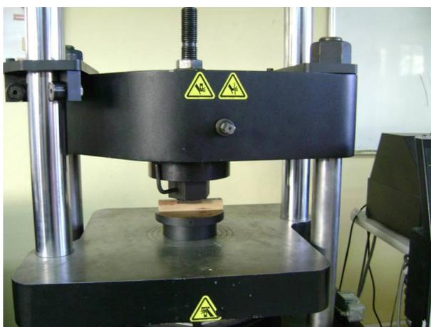
Figura 25. Ensayo de compresión perpendicular en probetas de *Dasyllirion cedrosanum Trel.*
