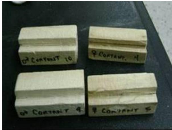
Figura 12. Probetas preparadas para ensayo de cizallamiento en escapos florales de *Dasyllirion cedrosanum* Trel.
