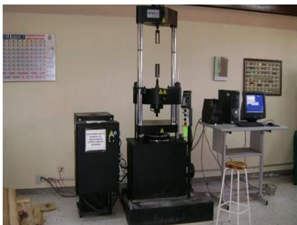
Figura 22. Máquina universal de ensayos utilizada en el instituto Tecnológico del Salto (ITS), Durango.
