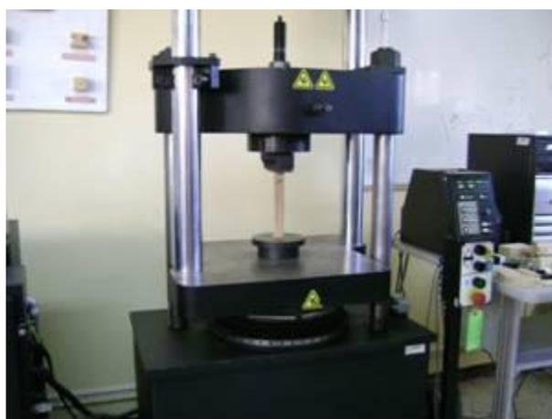
Figura 24. Ensayo de compresión paralela en probetas de *Dasyllirion cedrosanum* Trel.
