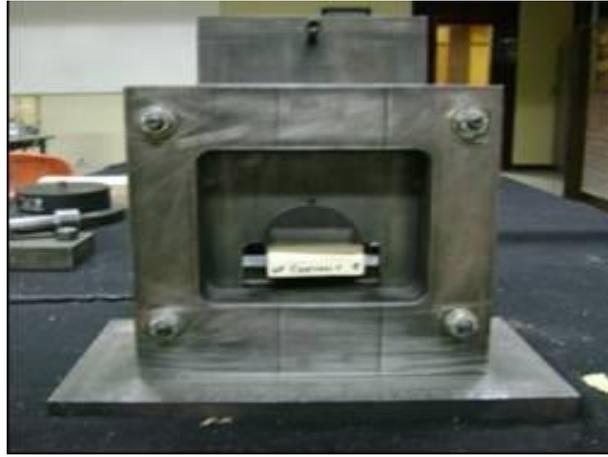
Figura 26. Ensayo de Cizallamiento en probetas de *Dasyilirion cedrosanum Trel.*
