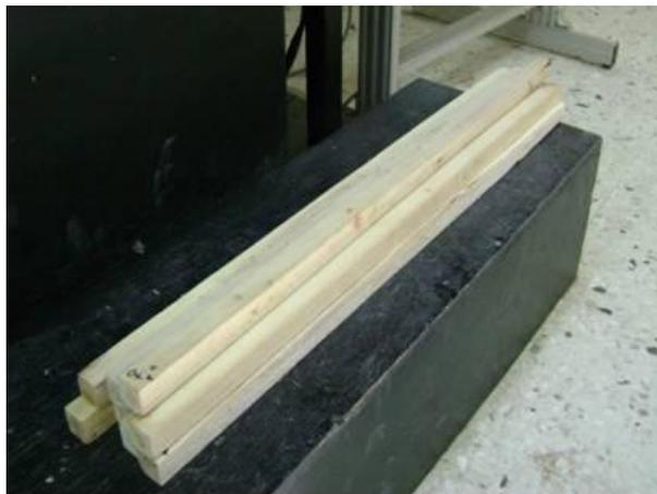
Figura 9. Probetas preparadas para el ensayo de Flexión estática en escapos florales de *Dasyllirion cedrosanum* Trel.
