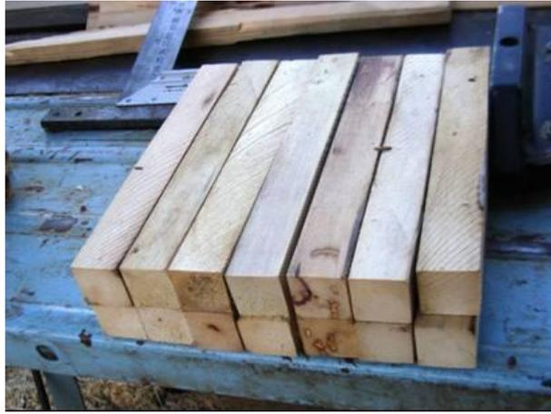
Figura 11. Probetas preparadas para ensayo de compresión perpendicular en escapos florales de *Dasyliirion cedrosanum* Trel.
