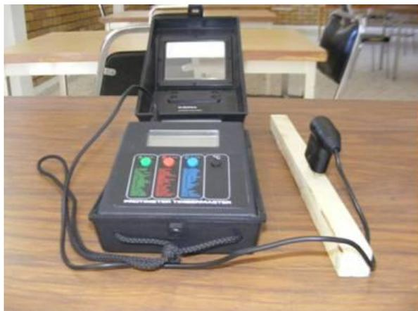
Figura 21. Xilohigrómetro eléctrico utilizado para medición de contenido de humedad en escapos florales de *Dasyllirion cedrosanum* Trel.
