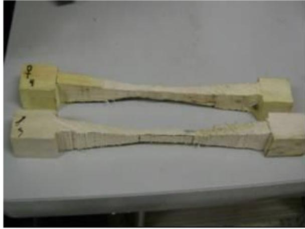
Figura 13. Probetas preparadas para ensayo de tensión paralela en escapos florales de *Dasyllirion cedrosanum* Trel.
