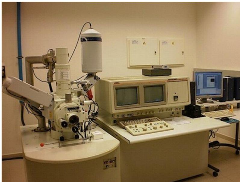
Figura 5. Microscopio electrónico de barrido (SEM) (Aguilar, 2019).
