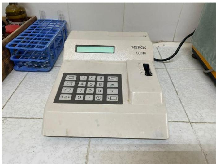
Figura 19. Equipo electrofotometro (MERCK SQ 118).
