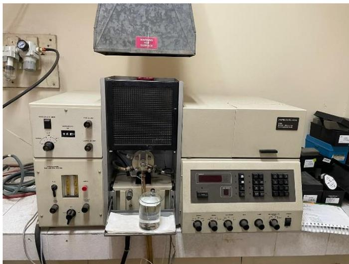
Figura 20. Equipo Espectrofotómetro de Absorción Atómica (PERKIN-ELMER 2380)
